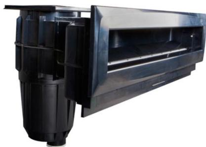
ABS, ширина всасывания 700x90 мм для бетонных, облицовочных и напорных бассейнов, уплотнение, набор винтов, сетчатая корзина, внутренняя резьба R 1 1/2 "+2" для высокого уровня воды 6-7 см.
