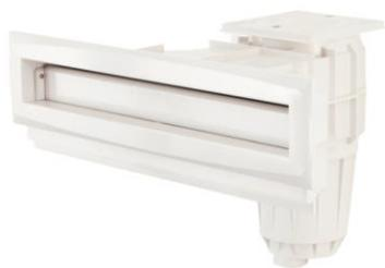
ABS, ширина всасывания 700x90 мм для бетонных, облицовочных и напорных бассейнов, уплотнение, набор винтов, сетчатая корзина, соединение с внутренней резьбой R1 ½ "+2" для высокого уровня воды 6-7 см
